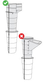
BOCA DESCARGA INICIAL: NÃO iniciar a coluna com boca descarga lateral. Boca descarga solta ou aparafusada.
