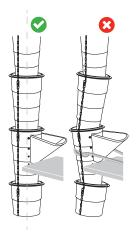
BOCA DESCARGA LATERAL: NÃO pressionar a parede desequilibrando a coluna. SIM manter vertical à coluna.
